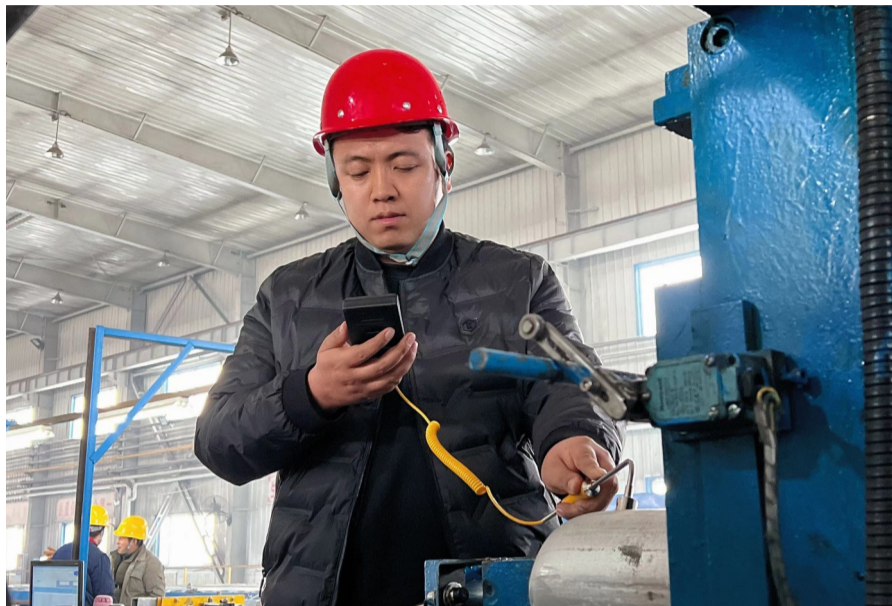
马小刚在挤压车间实际测量铝棒温度。
