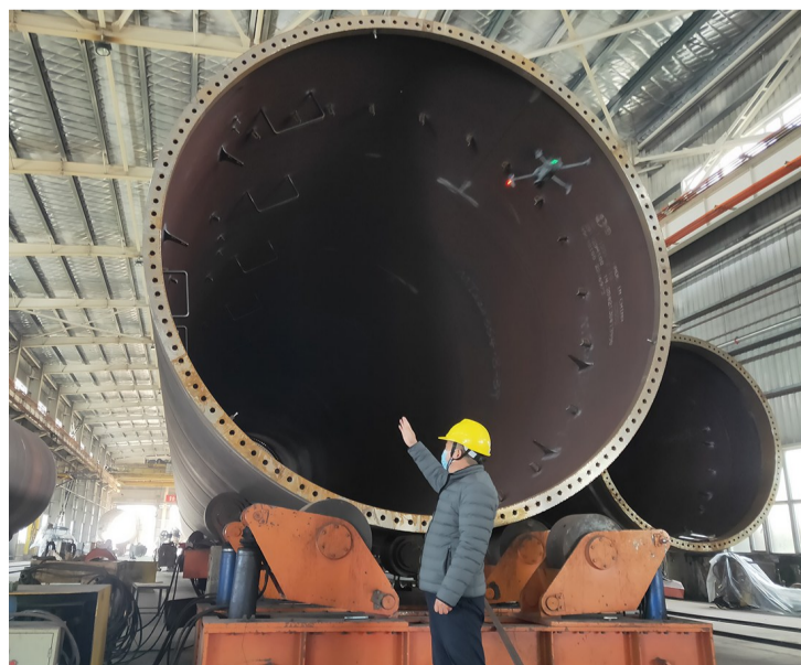
左图:3月8日,木垒县泰胜新能源有限公司风机塔筒制造车间内,工人正在查验风机塔筒法兰等部件质量。
