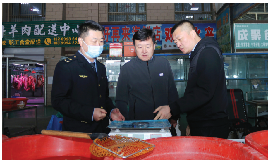
4月4日,新疆岐峰农副产品交易市场,州市场监管局执法人员用标准砝码对电子计价秤进行称重检测。 本报记者 付小芳 摄
