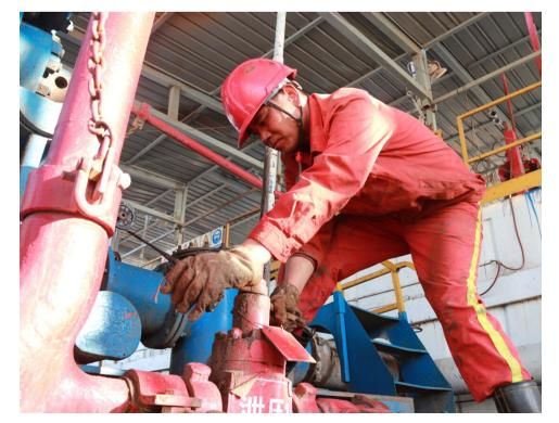
5月31日,土哈油田准东项目部萨探1区,石油工人正在进行起下钻作业。
