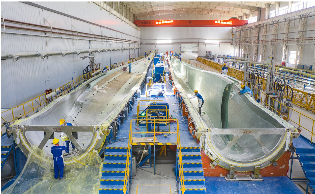
6月5日,昌吉国家高新技术产业开发区新疆成飞新材料有限公司风电叶片生产车间,工作人员在生产风力发电机组叶片。昌吉国家高新技术产业开发区新疆成飞新材料有限公司风电叶片生产基地总投资4.02亿元,分二期建设,一期于2022年10月开工建设,今年2月底复工,布局4套百米级风电叶片生产线,目前进入试生产阶段。项目建成后,每年可生产300套93米以上大型风电叶片,提供就业岗位800余个,预计年产值超过8亿元,将为昌吉州乃至全疆风电新能源产业发展提供坚实装备支撑。
